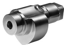
Кулачковый вал в виде сердечка в доводчике TS 97 обеспечивает стремительное снижение сопротивления при открывании двери, что гарантирует на практике легкость открывания и доступность дверей даже детям, пожилым людям или людям с ограниченными возможностями. Удобное и надежное закрывание
