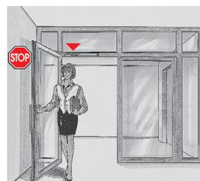
**Механический фиксатор открытого положения** позволяет удерживать дверь в открытом положении при заданном угле вплоть до 120°. Устройство подходит как для левых, так и для правых дверей, и им можно дооснастить уже установленные и функционирующие доводчики.
